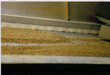
上) 工場内では巨大なミキサーで魚を粉碎。粉状になったものがパックされ、だしパックとなります。右) 粉のレバーで碎かれると、ベルトコンベヤーで運ぶのは難しい。そのため、振動コンベヤーを使って運びます。左) 焙煎され、カラカラに乾いた状態で入荷された魚を一度蒸し上げます。その後、破碎・削り作業を施することで、濃厚なだしを取れる割りパックになります。
